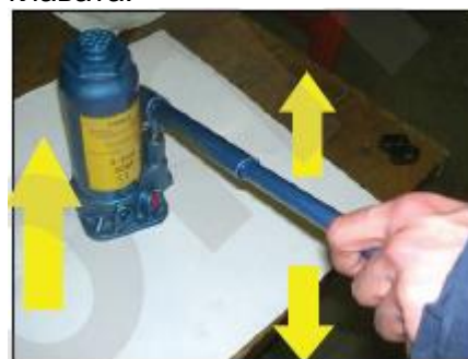
Фигура 9 – Помпене за повдигане.
